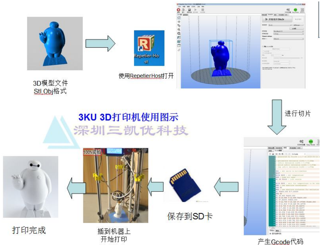
图 1 三凯优 3D 打印机使用图示
